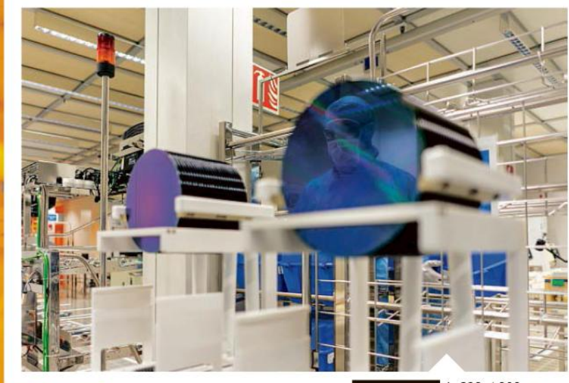
Plaquettes de 200 et 300 mm, les deux tailles produites à Crolles.
