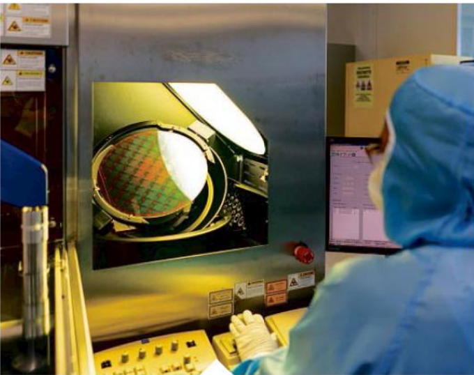
Inspection visuelle des plaquettes de 300 mm dans la zone de métrologie.
