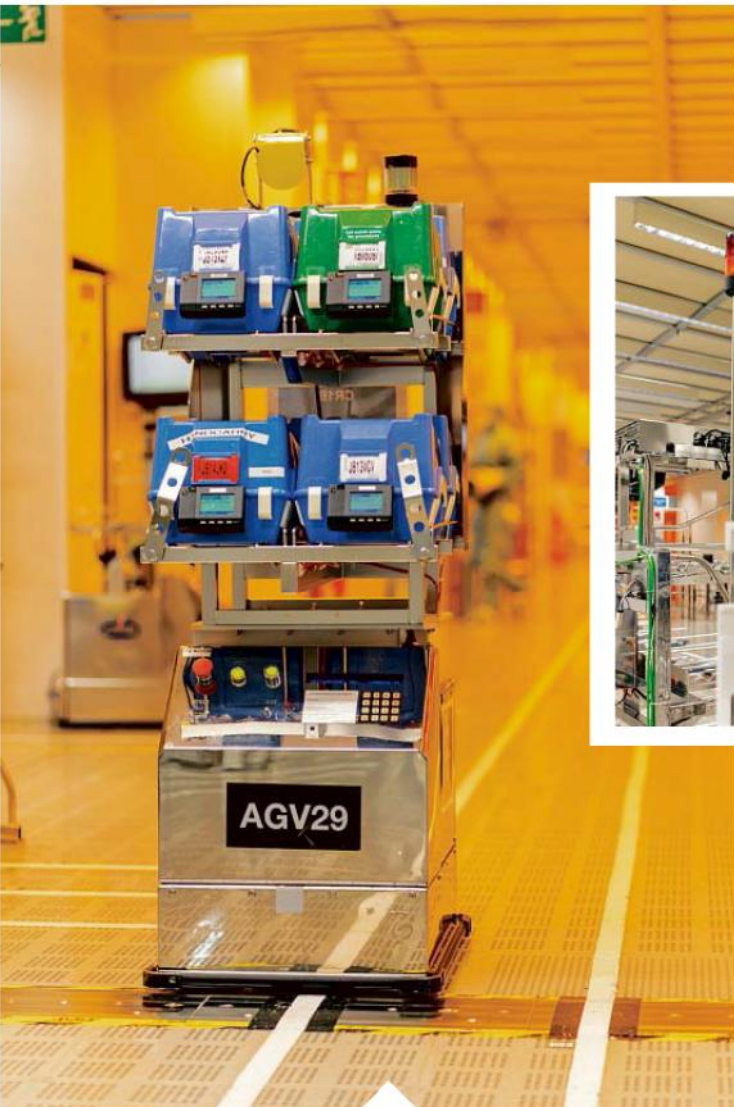
Chariot automatique filoguidé de convoyage des produits à l'usine Crolles 1 de plaquettes de 200 mm.
